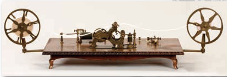
エンボッシング・モールス電信機(ペリー将来/米国製)(郵政博物館蔵)【国指定重要文化財】
