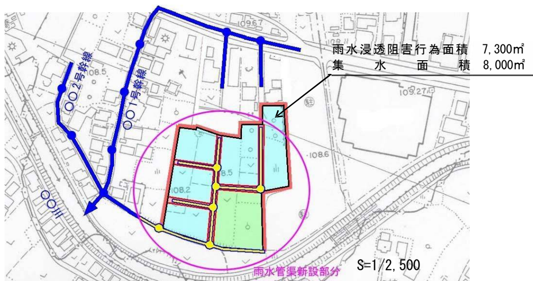
排水施設計画平面図の例
