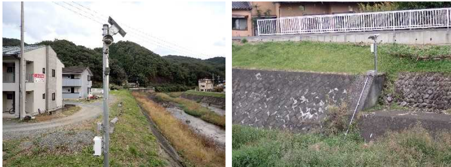
図-5.1 河川監視カメラ・危機管理型水位計（桐生川）
