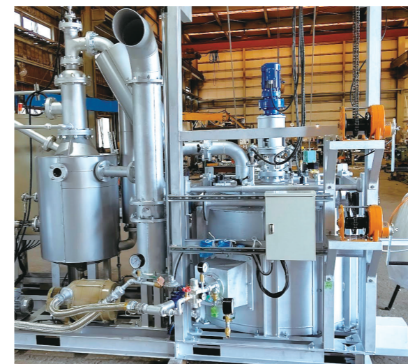
熱分解処理装置
