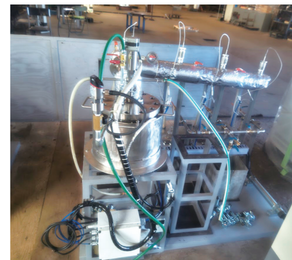
加圧水熱分解処理装置
