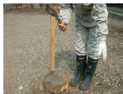
(悪い例) 離れている 手の方に刃が落ちてくる可能性あり
