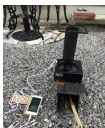
図4. ロケットストーブにミニ熱電発電装置を載せてスマホを充
