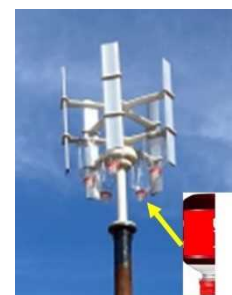
図2.ガイド取り付け改修工事後の風車 カットしたペットボトルを5本取り付けた
