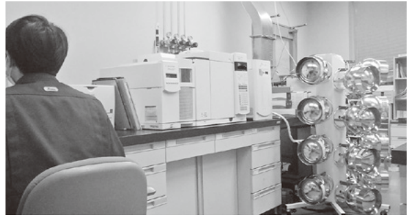
有害大気汚染物質測定の様子
