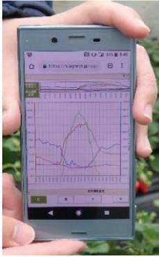
パソコンやスマートフォンでハウスの自動・遠隔制御と温湿度、炭酸ガス、日射量をモニタリングし、管理の省力化を図りました。
