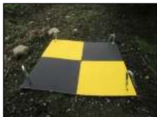
←GCPとして対空標識を設置した例
