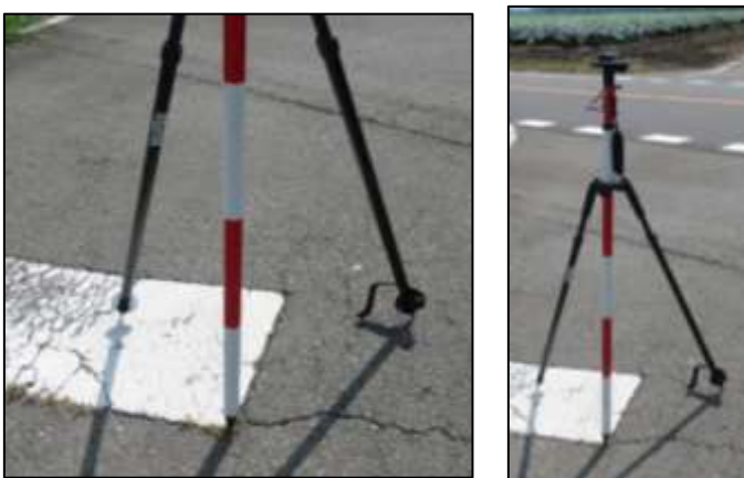
GCPとして、道路の白線を使用した例
