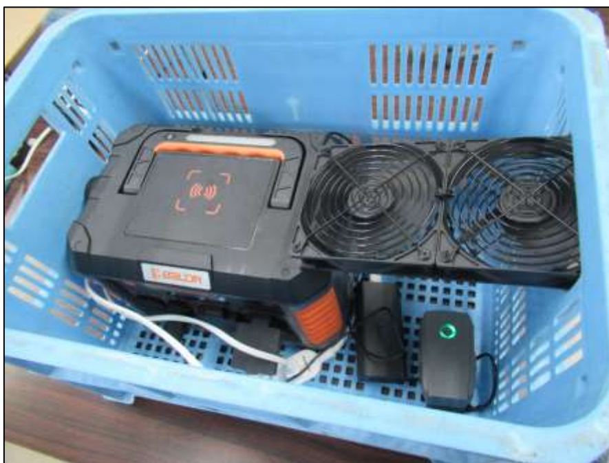
送風機を使用しバッテリーを冷やしながらか充電をする様子
