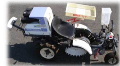
移植同時粒剤植穴施用装置 (群馬県開発)
