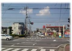
電柱や架空線は台風や地震時などの 災害時には、電柱倒壊や電線切断等 の二次災害の原因となる危険性があ ります。電線類の地中化によって、 これらの問題を解決します。
