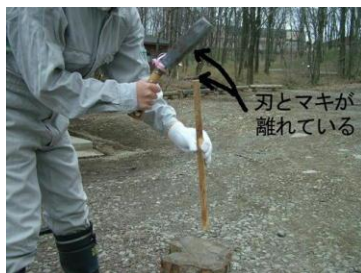
(悪い例) 離れている 手の方に刃が落ちてくる可能性あり
