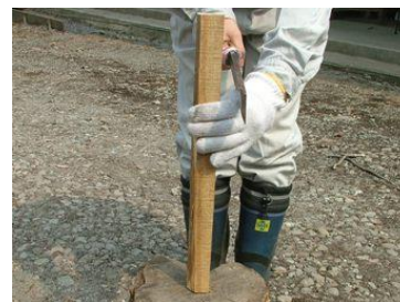
(悪い例) 離れている 手の方に刃が落ちてくる可能性あり
