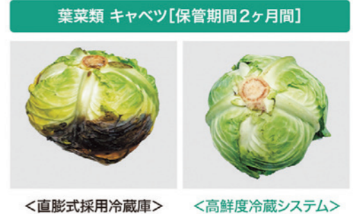
葉菜類 キャベツ【保管期間2ヶ月間】 ＜直膨式採用冷蔵庫＞ ＜高鮮度冷蔵システム＞
