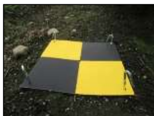
←GCPとして対空標識を設置した例
