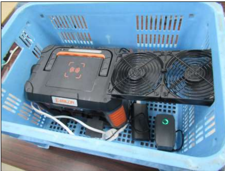
送風機を使用しバッテリーを冷やしながらか充電をする様子
