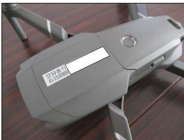
飛行させる機体に登録番号を表示している例
