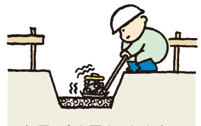
転圧（突き固め）します。
