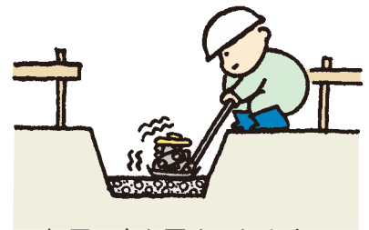
転圧（突き固め）します。
