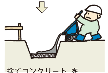
捨てコンクリートを流し込み
