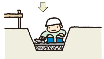
捨てコンクリートを水平にします。
