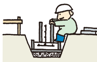
型枠（かたわく）を組み立てます。
