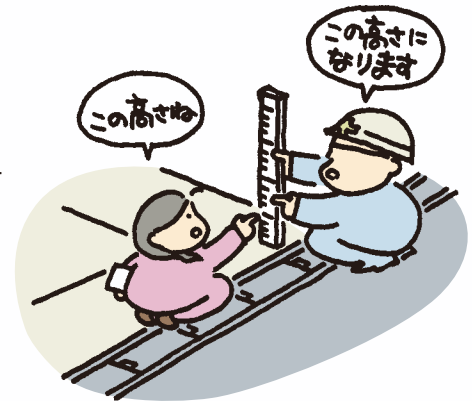
設計地盤面の高さの確認
