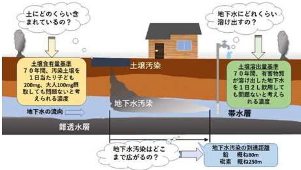
(2) 土壤汚染対策法では、地下水経由の摂取と直接摂取の2つの摂取経路による健康被害を防止するため、摂取経路の管理、摂取経路の遮断又は土壤汚染の除去により措置が講じられる。
