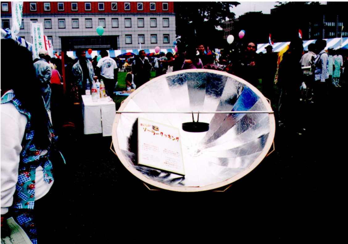
ソーラークッカー (パラボラ式太陽 熱集中器)
