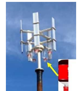
図2. ガイド取り付け改修工事後の風車 カットしたペットボトルを5本取り付けた
