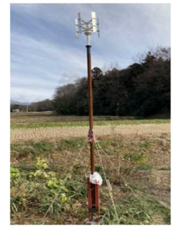
図1. ミニ風力発電装置（垂直型5翼）設置直後
