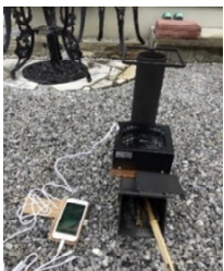
図4. ロケットストーブにミニ熱電発電装置を載せてスマホを充電
