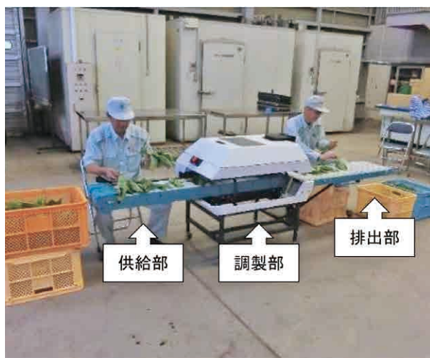
写真 新型調製機での作業の様子
