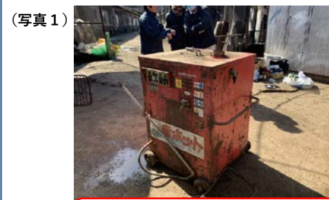
(写真1) 事故発生時はパレット上に、高圧洗浄機が設置されていた。
