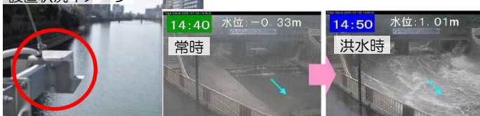
簡易型河川監視カメラ
