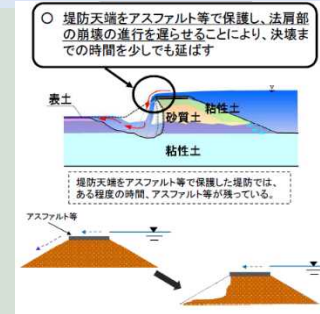
粘り強い堤防構造イメージ図
