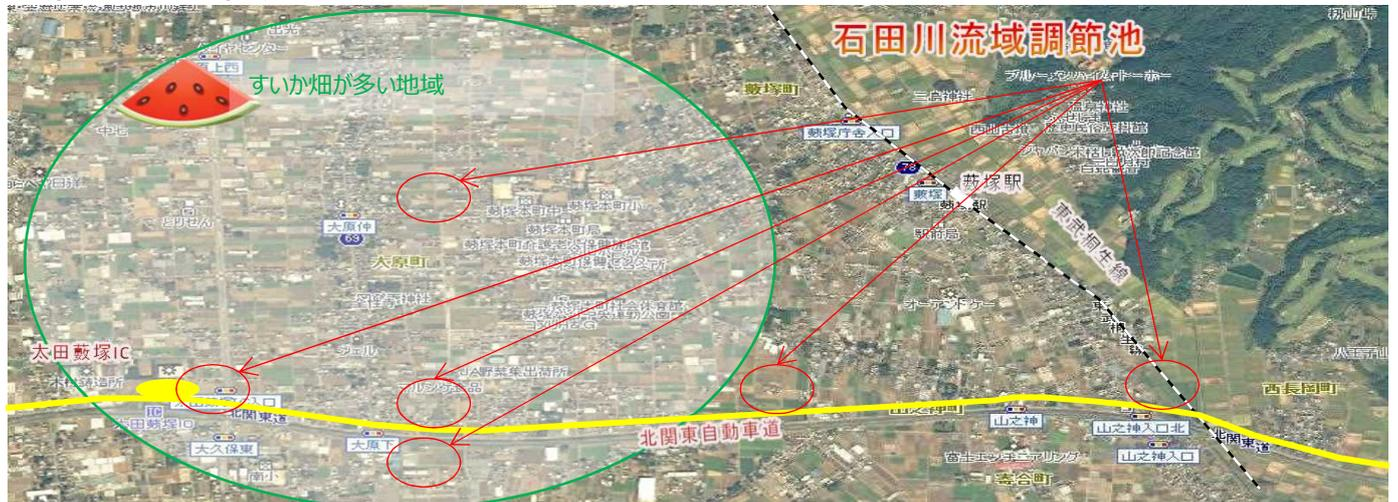
藪塚地区は扇状地に位置し、一級河川がありません。そのため、雨水は農地の地下へ浸透したり田畑に一時的に貯留したりして下流の河川への流出を自然に調節していました。しかし、開発によりその機能が失われ、浸水被害が懸念されるため、調節池の整備により雨水を貯留し、浸水範囲を減らします。
