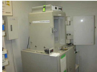
ゲルマニウム半導体検出器 (食品等の放射性物質濃度を測定します)
