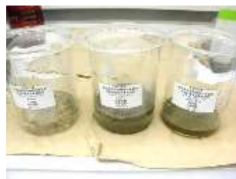
図 2-16 過酸化水素水による前処理
