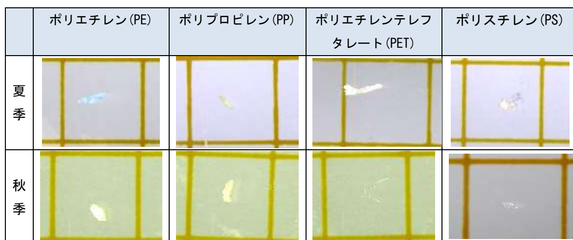
図 2-39 採取されたマイクロプラスチック
