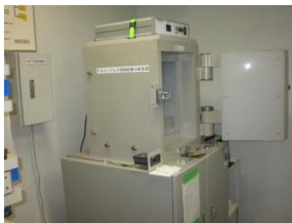
ゲルマニウム半導体検出器 (食品等の放射性物質濃度を測定します)
