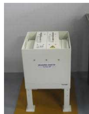
教育事務所に設置されているNaIシンチレーション検出器
