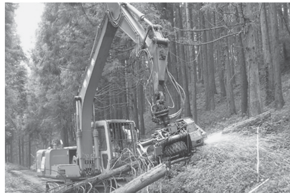
高性能林業機械（プロセッサ）による造材作業（枝払い・玉切り）
