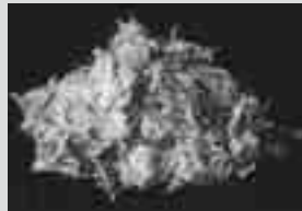
青石綿（クロシドライト）
