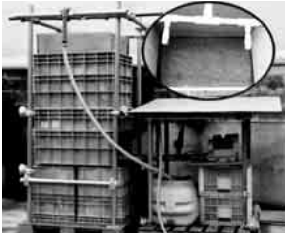
モミガラ脱臭装置
