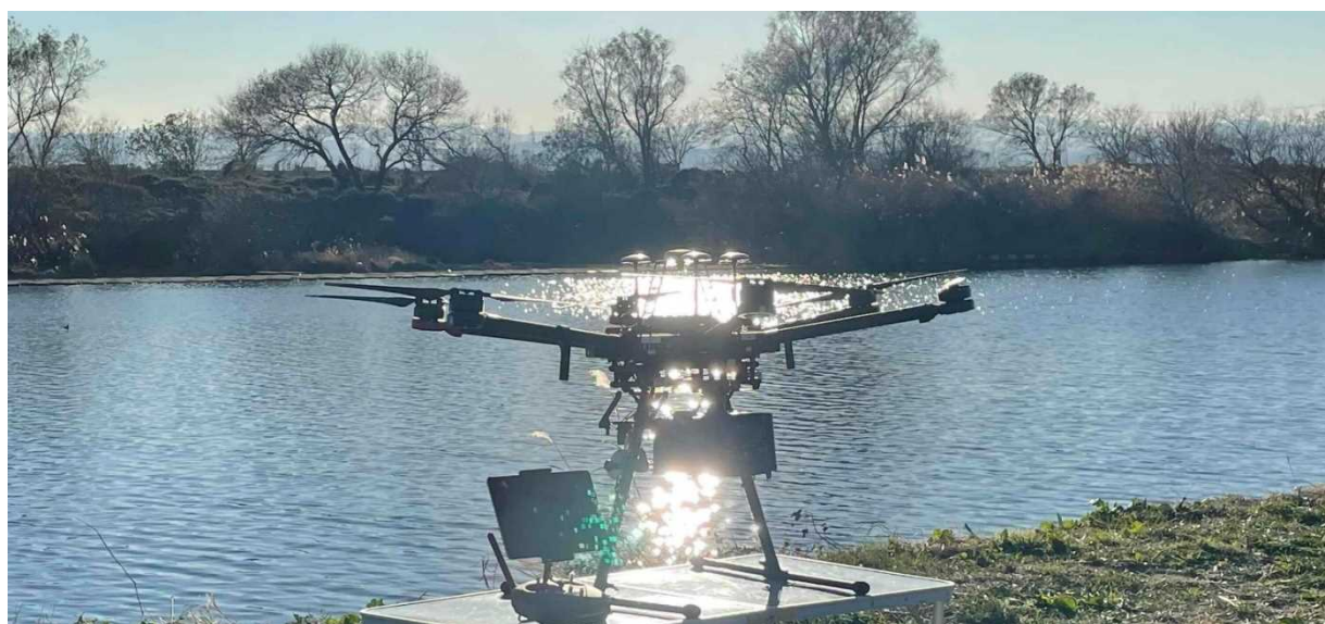
東毛工業用水道事務所 UAV（ドローン）による河川測量
