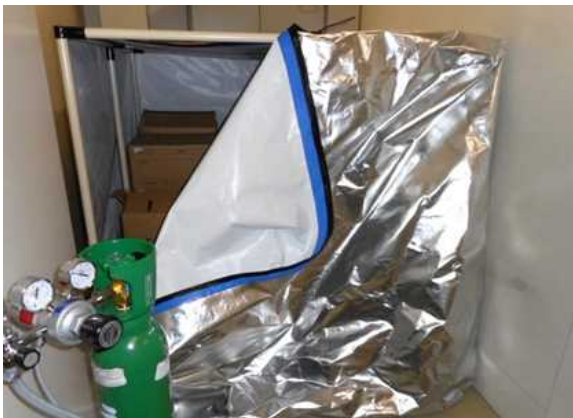
（写真8）炭酸ガス処理装置 （炭酸ガス処理バック）
