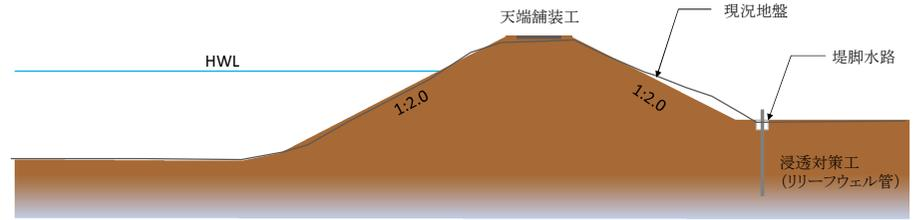
図 4.2.3 代表横断面図（堤防強化対策）
