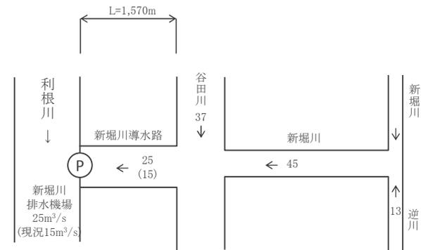
図 4.11 流量配分図（新堀川導水路）
